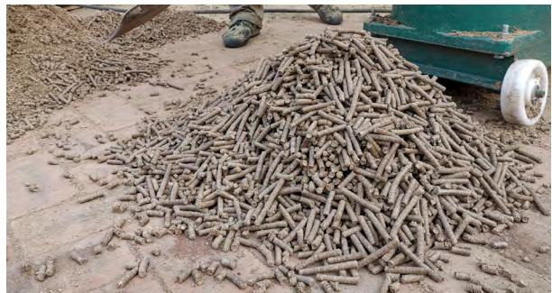
生物质是指由光合作用而产生的各种有机体，主要包括农林剩余物、薪柴、秸秆、人畜粪便、城镇生活垃圾等。生物质成型燃料是把生物质经过机械压缩制成燃料块，可以在锅炉或炊事灶具中直接燃烧利用，是一种温室气体零排放的清洁可再生能源。成型颗粒料可替代散煤的优质环保燃料。
